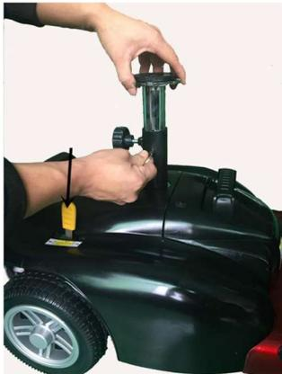
La palanca amarilla es la palanca de freno manual.
